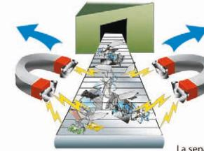
La separazione dell'acciaio è effettuata tramite l'utilizzo di magneti che attraendo il materiale ferroso lo separano dal resto.
