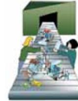
Il vetro recuperato ridotto in piccole pezzature omogenee diventa il cosiddetto "pronto al forno".
